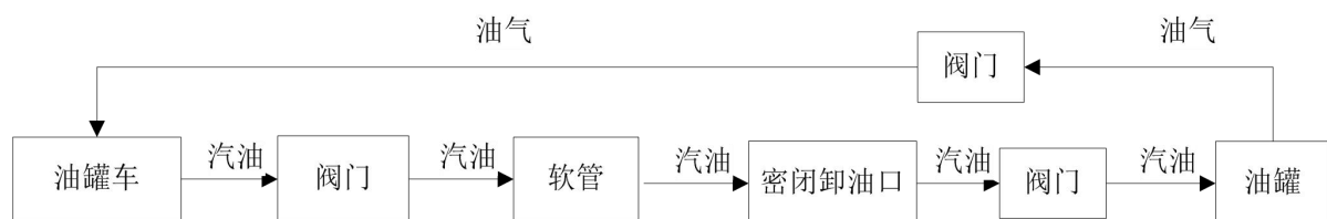
图 2-2 汽油卸油工艺流程方框图
